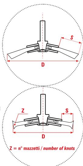
**CO, CZ** In acciaio ondulato ad alta resistenza o a mazzetti ritorti. La forma conica le rende adatte per lavori di taglio su superfici irregolari, con spigoli, profili e fessure.
